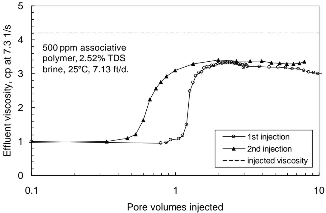
Fig. 29—Effluent viscosities.
